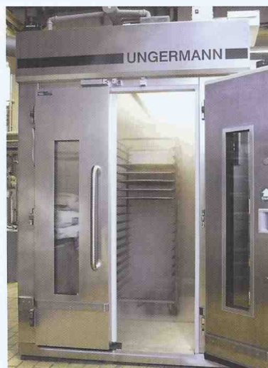
Gärvollautomat im Bremerhavener Institut für Lebensmitteltechnologie und Bioverfahrenstechnik.
